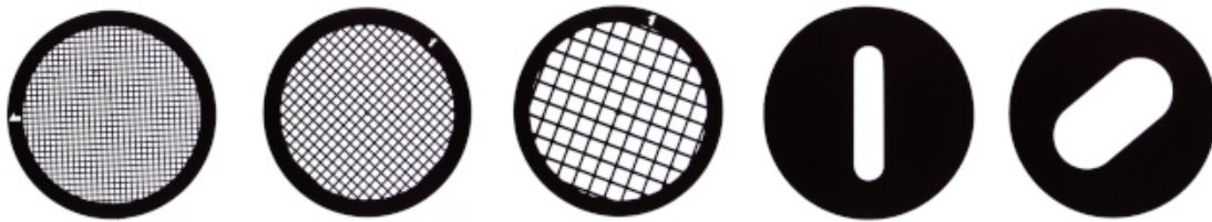
Figura 20: Tipos de rejillas para la recojida de cortes ultrafinos.
