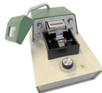
Figura 4: Vibratomo. La cubeta, de color negro, ha de estar llena de tampón de trabajo durante el proceso de corte de manera que la cuchilla y la muestra, de color rojo, y las secciones que se obtienen están sumergidos.
