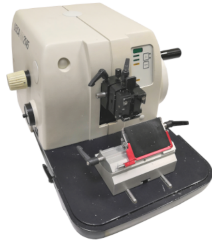
Figura 6: Microtomo para parafina con mecanismo de rotación.
