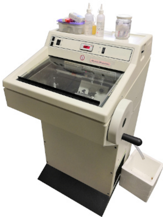
Figura 14: Criostato. El compartimento de color azul es la cámara refrigerada a la temperatura seleccionada. En esta cámara se encuentra la muestra, la cuchilla y es donde se recogen las secciones.
