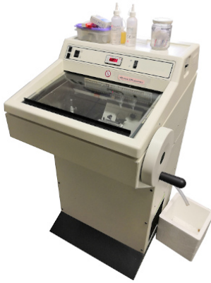
Figura 5: Criostato. El compartimento de color violeta es la cámara enfriada a la temperatura seleccionada. En esta cámara se encuentra la muestra, la cuchilla y es donde se recogen las secciones.
