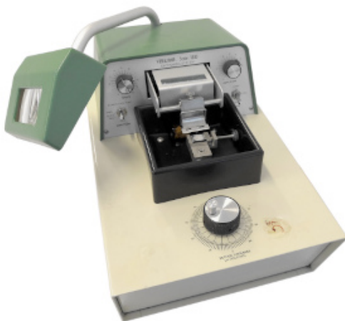
Figura 10: Vibratomo. La cubeta, de color negro, ha de estar llena de tampón de trabajo durante el proceso de corte de manera que la cuchilla y la muestra, de color rojo, y las secciones que se obtienen están sumergidos.
